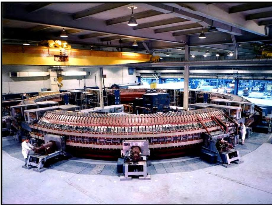
**Cosmotron:** 1<sup>st</sup> proton synchrotron.
