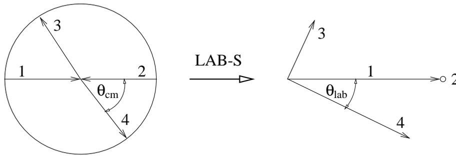
Abbildung 1.4: Transformation von dem Schwerpunktsystem einer Zweikörperreaktion in ein dazu bewegtes System.
