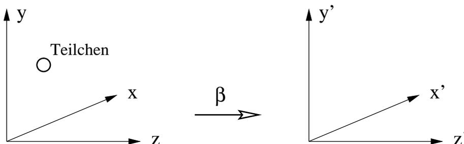
Abbildung 1.1: Der Boost des Koordinatensystems mit der Geschwindigkeit  $+\beta$  in z-Richtung ist äquivalent einem Boost des Teilchens in die entgegengesetzte Richtung.
