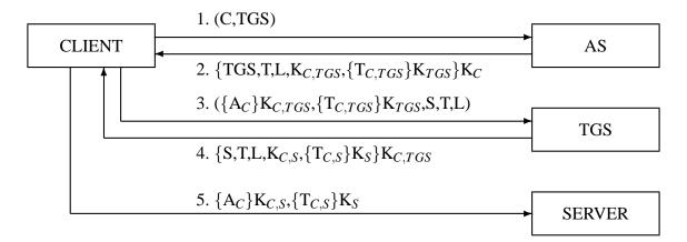
Abbildung 1.3: Nachrichtenaustausch zum Erhalt eines TGT und eines Service-Tickets (nach [6])
