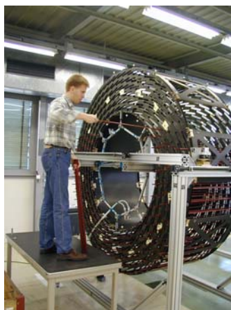
CMS: Trägerstruktur aus CFK
