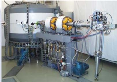
Das **CYCLONE 18/9** ist ein computergesteuertes Zyklotron zur Herstellung von PET-Radionukliden. Die Herstellung der Radionuklide erfolgt durch Bestrahlung von Flüssigkeiten und Gasen. Nach dem Transport in radiochemische Laboratorien werden die Radionuklide für die Synthese verschiedener PET-Radiotracer verwendet.
