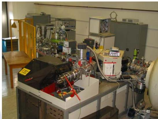
**Zusätzlicher Helium-Injektor am 3-MV-Tandetron**
