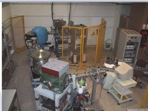
100-kV-Tandembeschleuniger für Tiefenprofil-Messungen
