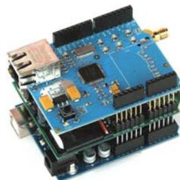
Arduino Uno mit Ethernet- und GSM/GPRS-GPS-shield
