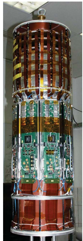
Backward Silicon Tracker mit 4 Ebenen
