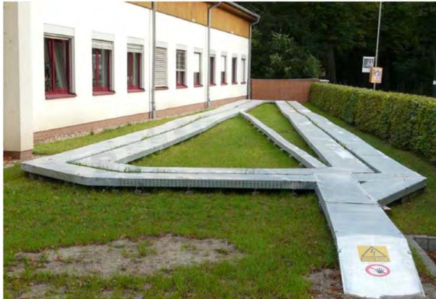
Kabeltrasse mit 625 Meter Puls-kabel am Modulator Teststand
