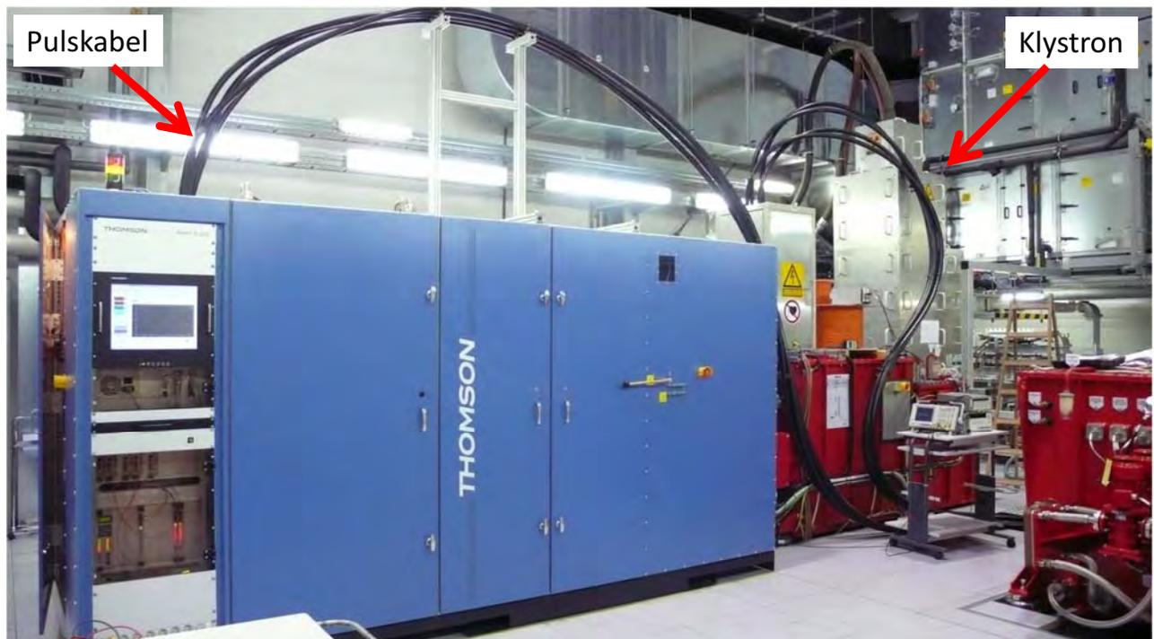
RF-Station mit Thomson Modulator und 5MW Klystron
